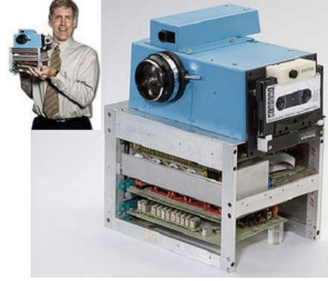
Resim 1.6: 1975 yılında Kodak tarafından yapılan ilk dijital fotoğraf makinesi
