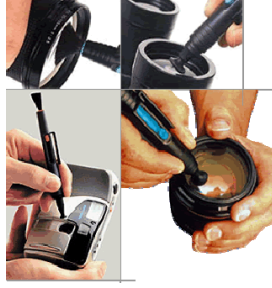
Resim 1.4: Temizleme solüsyonlu lens temizleme kalem kullanımı
