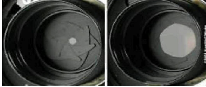
Şekil 1.3: Küçük açıklık(sol) f:22, büyük açıklık ise(sağdaki) f:2 değeri
