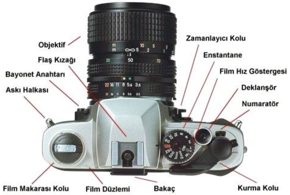
Şekil 1.2: Fotoğraf makinesinin bölümleri
