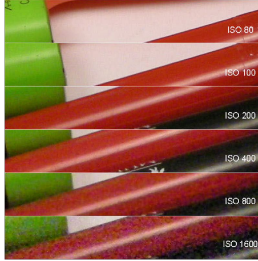
Şekil 1.31: ISO değerleri yükseldikçe görüntü kalitesinin bozulması
